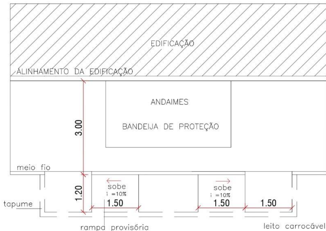
PLANTA BAIXA - OBRAS SOBRE O PASSEIO
